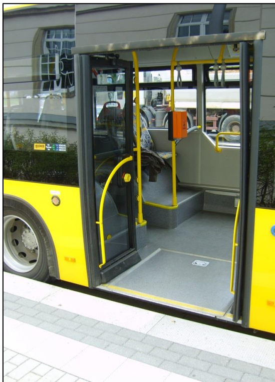
Rys. 31 Przerwa między peronem przystankowym i autobusem (Drezno) 59
