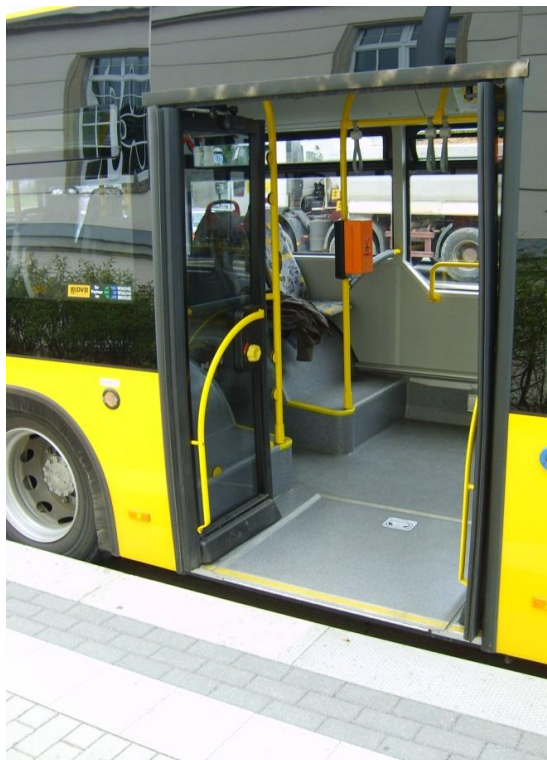
Rys. 30 Przerwa między peronem przystankowym a autobusem 61
